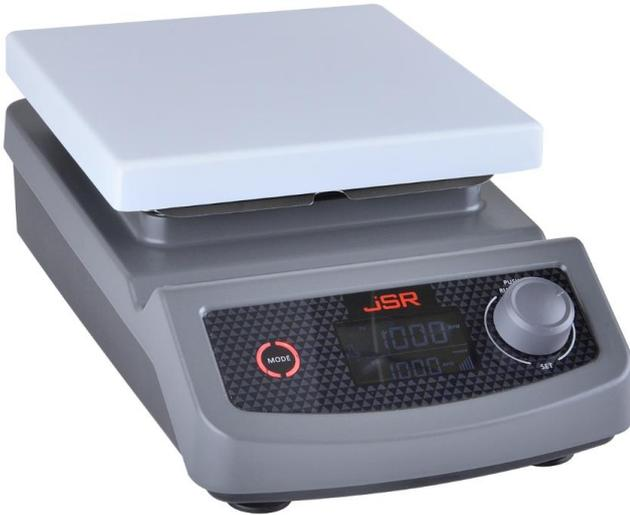
JSHS-18D 디지털 핫플레이트 마그네틱 스테러는 가장 진보된 디지털 퍼지 제어 기술을 사용하여 온도, 교반속도, 시간을 제어합니다. 최대 가열 온도 400°C 온도 해상도 0.1°C, 교반속도 80 ~ 1500 rpm, 타이머 최대 99시간 59분 까지 설정할 수 있습니다.
